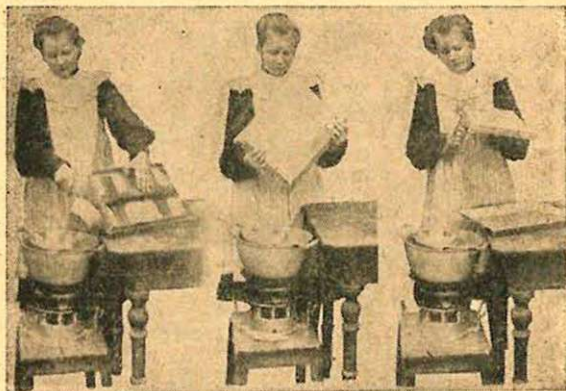
54. ábra. Mülép-préselés. Első a présbe önti a viaszt, második kiönti a prés szélére kiszorult viaszt, harmadik lefejt a mülépet a prés felső részéről.
