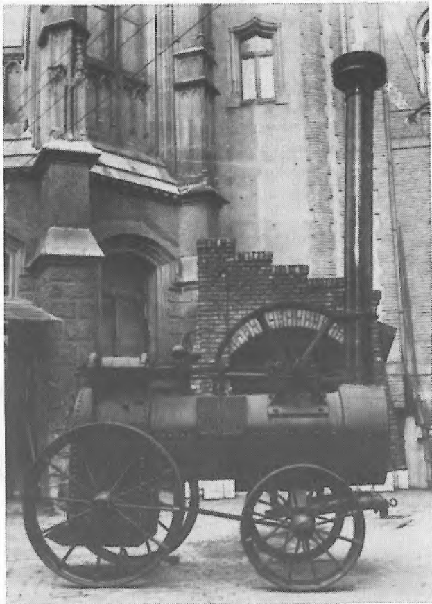
2. sz. fotó: A Magyarországon elsőként üzemelt (1852-től gabonacséplésnél) Clayton-Shuttleworth gyártmányú gőzlokomobil.
